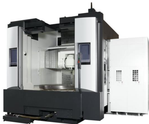
Okuma VTM-2000YB, vertikal multifunktionssvarv, 5-axlig (max sving 2400 mm)
